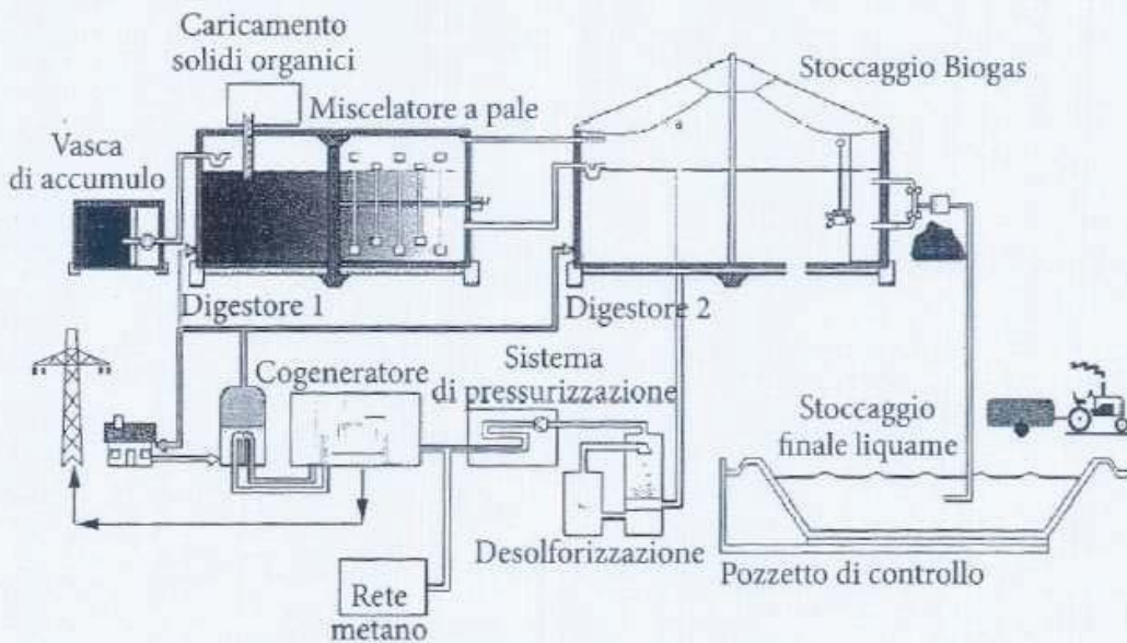
Figura - Schema di impianto semplificato di digestione anaerobica, ricavato dalla copertura di una laguna di stoccaggio dei liquami.
